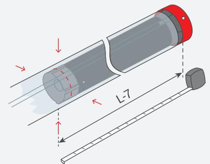
6. Fixer le tube d'enroulement au roulement, avec quatre vis ou rivets placés à une distance L de 7 mm du bord intérieur de la tête.
