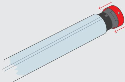
5. Faire glisser le moteur dans le tube d'enroulement de façon à ce que le bord du tube adhère au bord interne de la tête.
