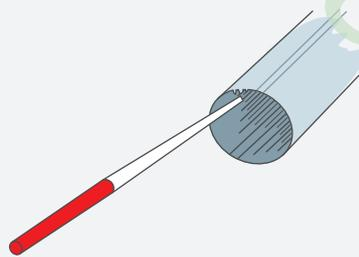
2. Enlever les copeaux et ébarbures du bord du tube d'enroulement.
