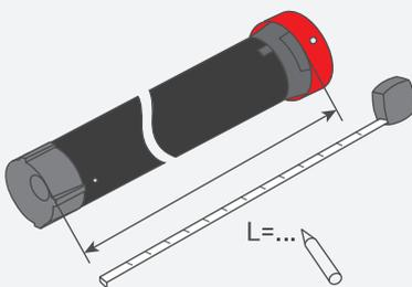
4. Mesurer la longueur L entre le bord interne de la tête et l'extrémité du roulement.
